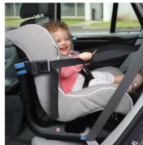
Representada como silla de grupo 1 en **sentido contrario a la marcha** del vehículo, fijada con los cinturones del automóvil y el cinturón adicional enganchado al punto de anclaje del "Top Tether" del sistema Isofix.
